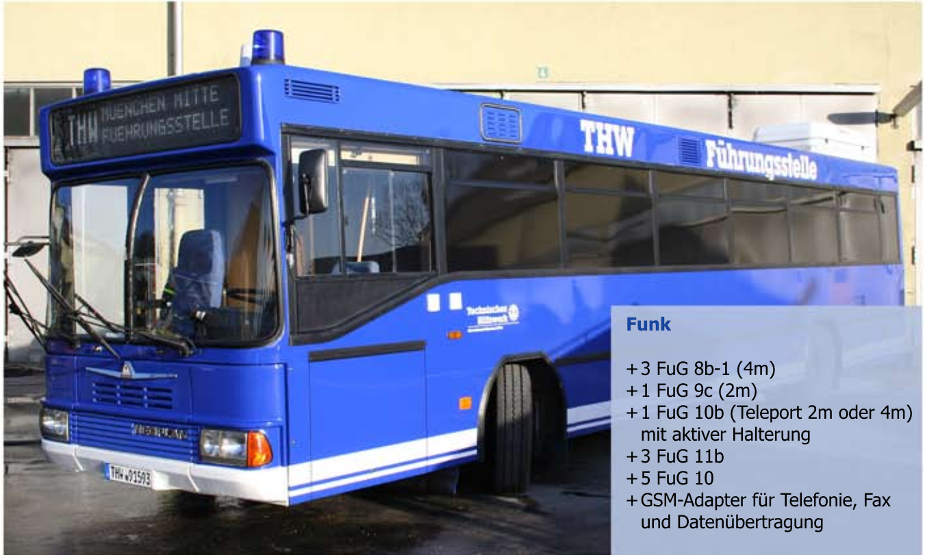
Mobile Führungsstelle für die Fachgruppe Führung und Kommunikation des OV München Mitte. Ausgestattet mit moderner Büro-, Funk und Fernmeldetechnik.
